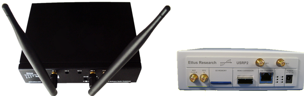
Abbildung 3.1: Universal Software Radio Peripheral Version 1 (links) und Version 2 (rechts)
