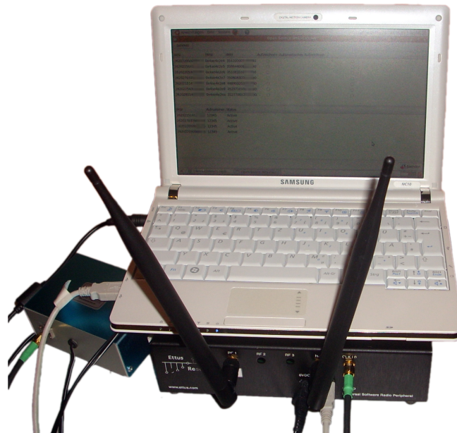
Abbildung 3.7: IMSI-Catcher in Betrieb mit dem USRP1 und dem Samsung NC10 Netbook
