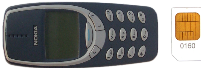
Abbildung 2.5: Mobile Station, bestehend aus Mobilfunktelefon und SIM-Karte
