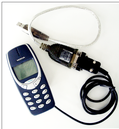
Abbildung 6.13: Nokia 3310 und MBUS NK-33 Datenkabel samt Seriell-zu-USB-Konverter
