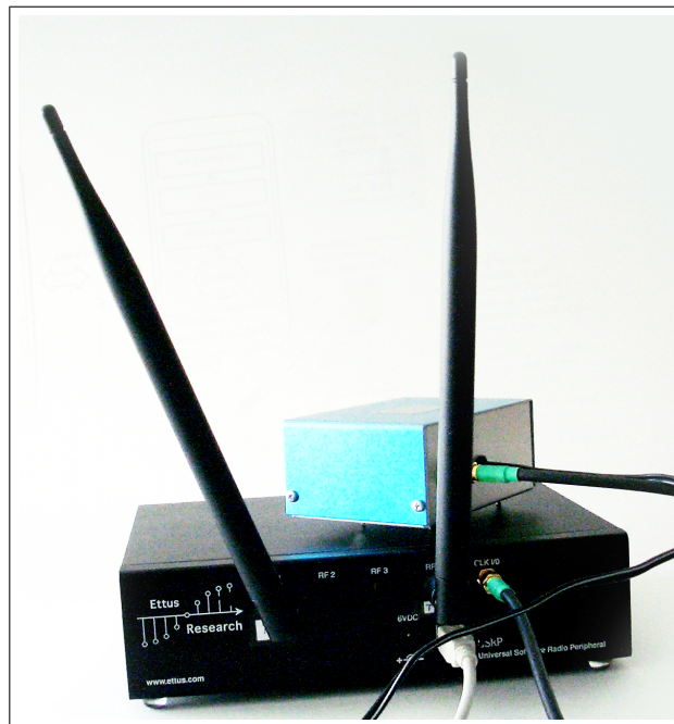
Abbildung 5.2: USRP mit externem Taktgeber und Antennen
