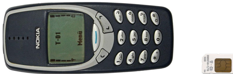
Abbildung 2.2.: Mobilstation aus Nokia 3310 und T-Mobile SIM-Karte
