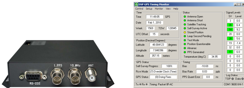
Abbildung 3.7.: Links: GPSDO von Trimble; Rechts: Monitor-Programm
