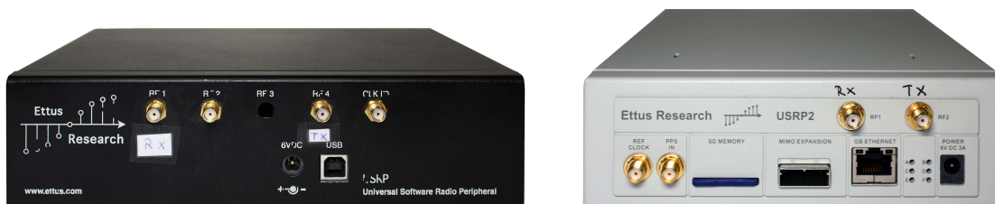
Abbildung 3.2.: Universal Software Radio Peripheral Version 1 (links) und Version 2 (rechts)
